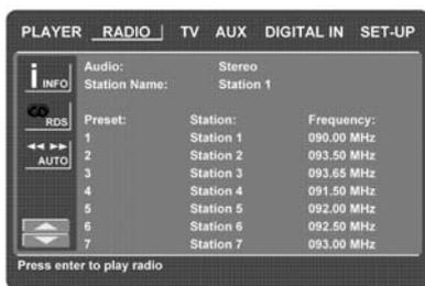
Меню RADIO показывает выбранный режим звука, название принимаемой в данный момент радиостанции (при наличии RDS) и список радиостанций, перечисляющий 30 станций с номером предварительной настройки, названием станции и ее частотой.
